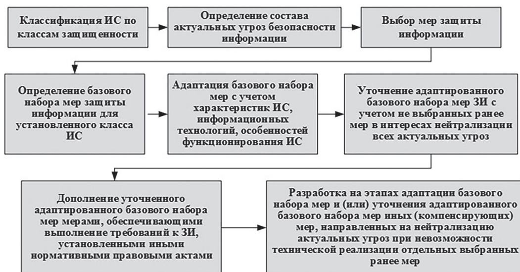
Рисунок 4. Порядок определения мер защиты информации в ИС (на примере ГИС в соответствии с Приказом ФСТЭК России от 11.02.2013 г. №17)
